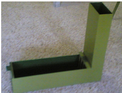
Figure (5): L-box apparatus
